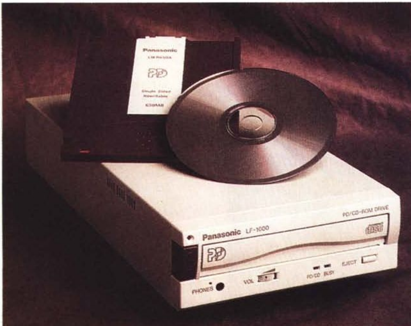
Ecco il drive multifunzione PowerDrive LF-1000AB di Panasonic: disco ottico riscrivibile e lettore CD-ROM a quadrupla velocità in un unico dispositivo.
